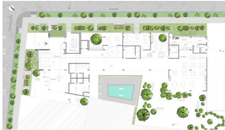
Figura 8. Planta Arquitectónica del primer piso
